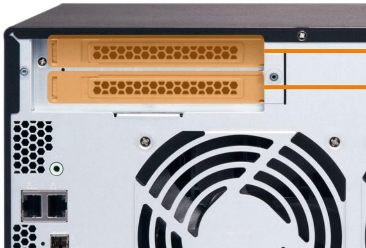
PCIe 1 : Gen2 x1 高達 5Gb/s 理論傳輸速度
